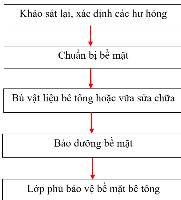
Hình 3.3: Sơ đồ trình tự sửa chữa kết cấu BTCT
