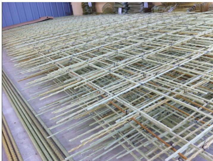
Hình 3.5: Cốt composite polyme thay thế cốt thép
